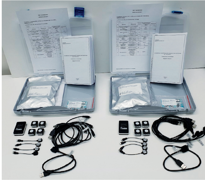
Рисунок 2 — Макетный образец устройства, включающий беспроводной усилитель ЭЭГ и четыре вибростимулятора.
